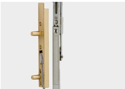
Verrouillage de sécurité pour châssis de fenêtre OF et OB, qui protège contre les conséquences éventuelles d'un mauvais fonctionnement et d'une surcharge. Le dispositif de sécurité, situé du côté des charnières, est intégré à la crémonne centrale oscillo-battante. Son câble d'acier résilient empêche l'ouvrant de tomber du cadre de la fenêtre et prévient efficacement les accidents éventuels.
