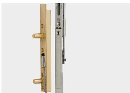
Verrouillage de sécurité pour châssis de fenêtre OF et OB, qui protège contre les conséquences éventuelles d'un mauvais fonctionnement et d'une surcharge. Le dispositif de sécurité, situé du côté des charnières, est intégré à la crémone centrale oscillo-battante. Son câble d'acier résilient empêche l'ouvrant de tomber du cadre de la fenêtre et prévient efficacement les accidents éventuels.
